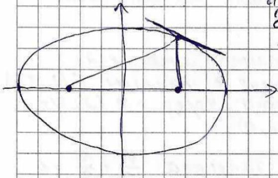
Угол касательной, с прямой, соединяющей точку касания с фокусом, равен.
